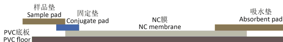
图 2 量子点免疫层析试纸条侧面结构示意图
